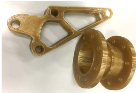
Stratasys: PEKK系,高性能熱可塑性樹脂 (Antero 800NA)
