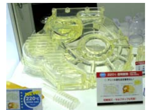
SL 5530 160℃×2時間のアニール後はセルフタップが難しい (割れや欠けが起こる)
