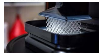
図A 米Carbon3D社のCLIP(Continuous Liquid Interface Production)方式 積層ではなく連続的に造形することから、従来の70~100倍の高速化が図れるという。米Carbon3D社の資料を基に本図作成。
