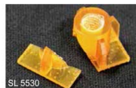
SL 5530 160℃×2時間のアニール後はセルフタップが難しい (割れや欠けが起こる)
