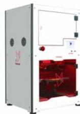
PEEK材料押出し(MEX)
