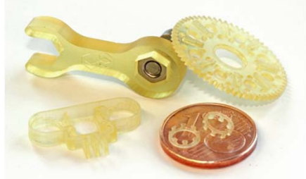
Cubicure Precision 低荷重HDT: 90°C/Charpy:20kJ/m 2
