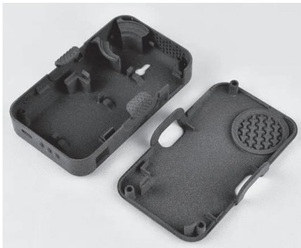
Fig.5. BASF 社 Ultrasint PA11 ESD 材料の粉末床溶融法 (PBF) 造形例； https://www.sculpteo.com/en/materials/sls-material/pa11-esd/
