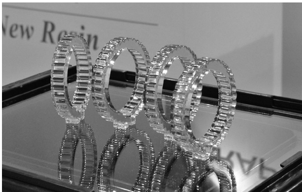
写真1 シーメット社の非アンチモン透明樹脂 TSR-890 の造形例
